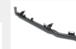
バンパ全域での正確な検知を実現した歩行者衝突検知センサ
