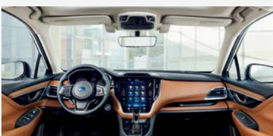
コックピット統合システム (センターディスプレイ、コンビネーションメータ、HMIコントロールユニット) 出典: SUBARU レガシイナビネ写真
