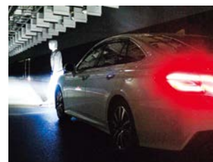
夜間歩行者 衝突被害軽減ブレーキ評価
