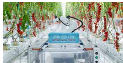
自動収穫ロボットによるミニトマトの収穫
