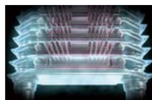
インバータの両面冷却構造
