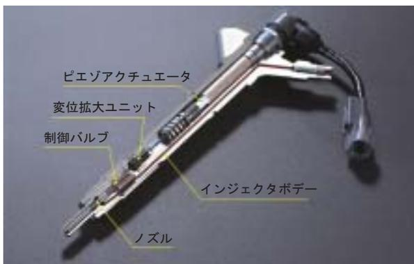
Fig. 6 ピエゾインジェクタの構造
