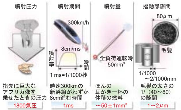
Fig. 3 1800bar・1msの超高压噴射の世界
