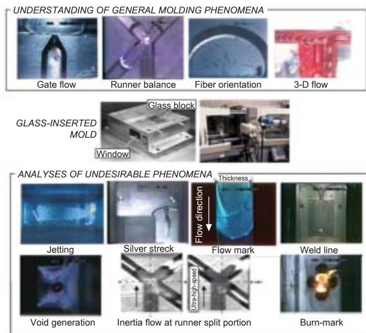
Fig. 2 金型キャビティ内の可視化画像例（その1）
