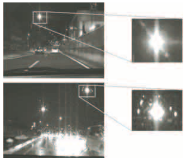
Fig. 3 夜間の車載カメラ映像と画像特徴: (上) 晴天 (下) 雨天
