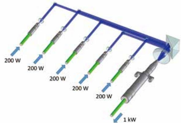
Fig. 9 1kW 青色半導体レーザービームコンバイニング技術の模式図
