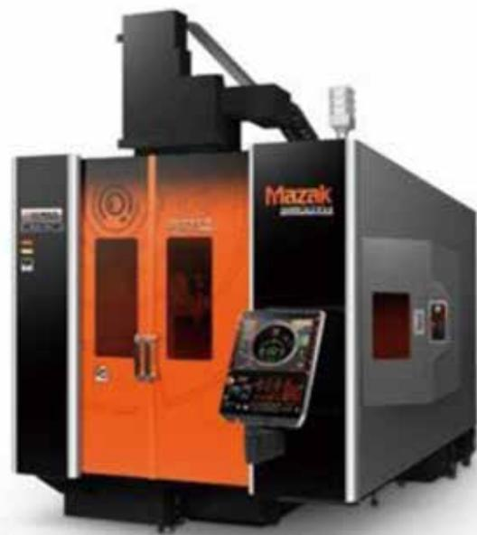
Fig. 8 青色半導体レーザー搭載複合加工機
