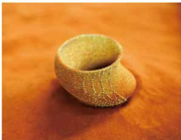
Fig. 11 簡易 3D プリンターでの純銅積層造形物
